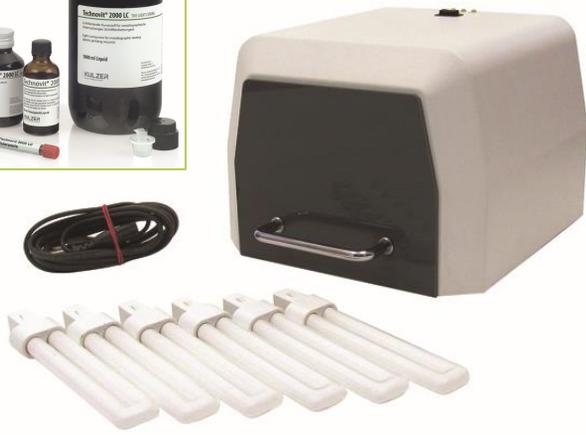
Technotray POWER は、Kulzer社製光硬化樹脂 Technovit 2000 LC シリーズの照射硬化に最適なブルーライトチャンバーです。
