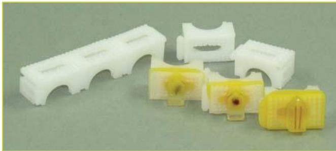
ミクロトームでの試料切断の際、サンプルのミクロトームへ確実な固定ができるよう設計された専用ブロックです。Technovit 7100 及び Technovit 8100 を、専用の固定樹脂 Technovit 3040 と組み合わせて使用します。長期保管が可能であり、また各々に嵌め込み式の継ぎ手がついているため、繋ぎ合わせて保管することも可能です。
