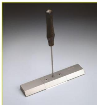
Technovit 7100 及び Technovit 8100 と呼ばれる HEMA(2-ヒドロエチルメタクリレート)ベースの樹脂で包埋したサンプルの試料片を切り出すのに最適な専用の使い捨て式ブレード及び専用のホルダーです。既存のロータリータイプのミクロトームで使用することができ、1  $\mu$ m 程度の厚さの試料片を得ることも可能です。
