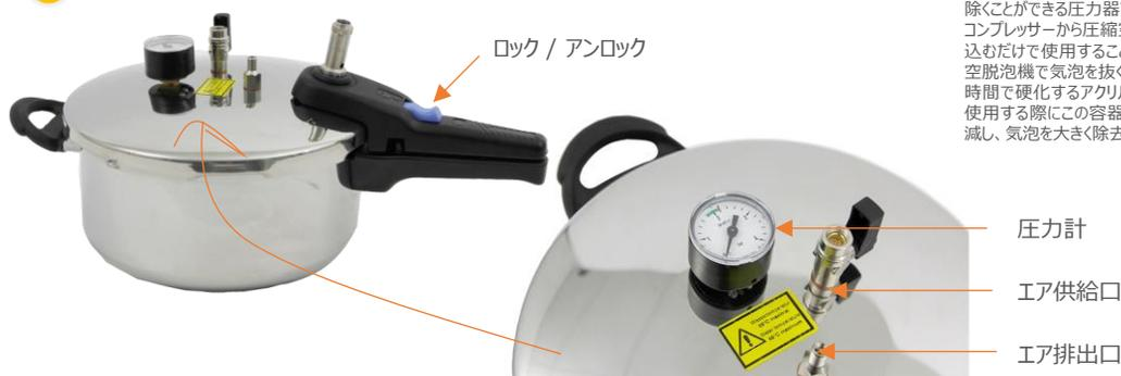
常温硬化樹脂の気泡を非常に簡単に取り除くことができる圧力器です。コンプレッサーから圧縮空気を吸入口に流し込むだけで使用することができます。特に真空脱泡機で気泡を抜くことができないほど短時間で硬化するアクリル樹脂KMシリーズを使用する際にこの容器を用いると収縮を低減し、気泡を大きく除去することができます。
