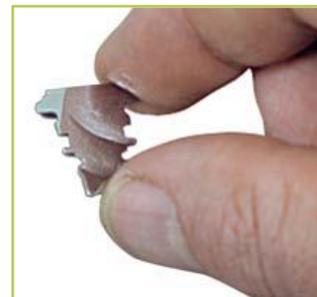
※ アセトンに浸した場合、室温で約 11 時間、50 °C の環境下で約 4 時間放置すると、試料を取り出すことが可能になります。熱に強い試料の場合、包埋した試料を 150 °C 程度に熱することで樹脂が柔らかくなります。単純な形状の試料の場合には、簡単に試料を取り出すことができます。
